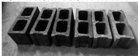
Figura N.º 8. Unidades de mampostería de concreto limpias previas de pasar ensayo de laboratorio
