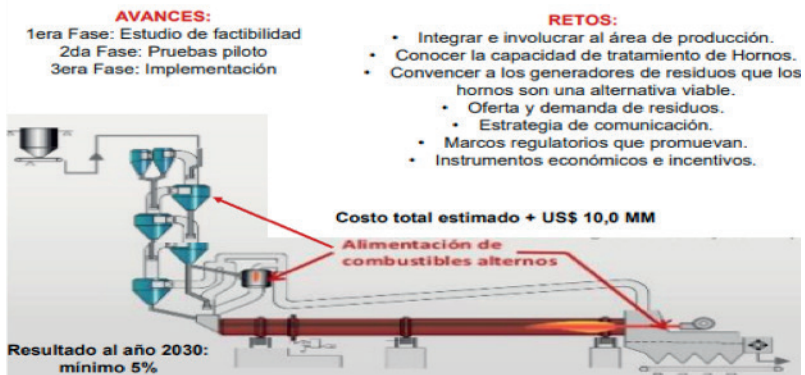
Fig.6 esquema de co-procesamiento
