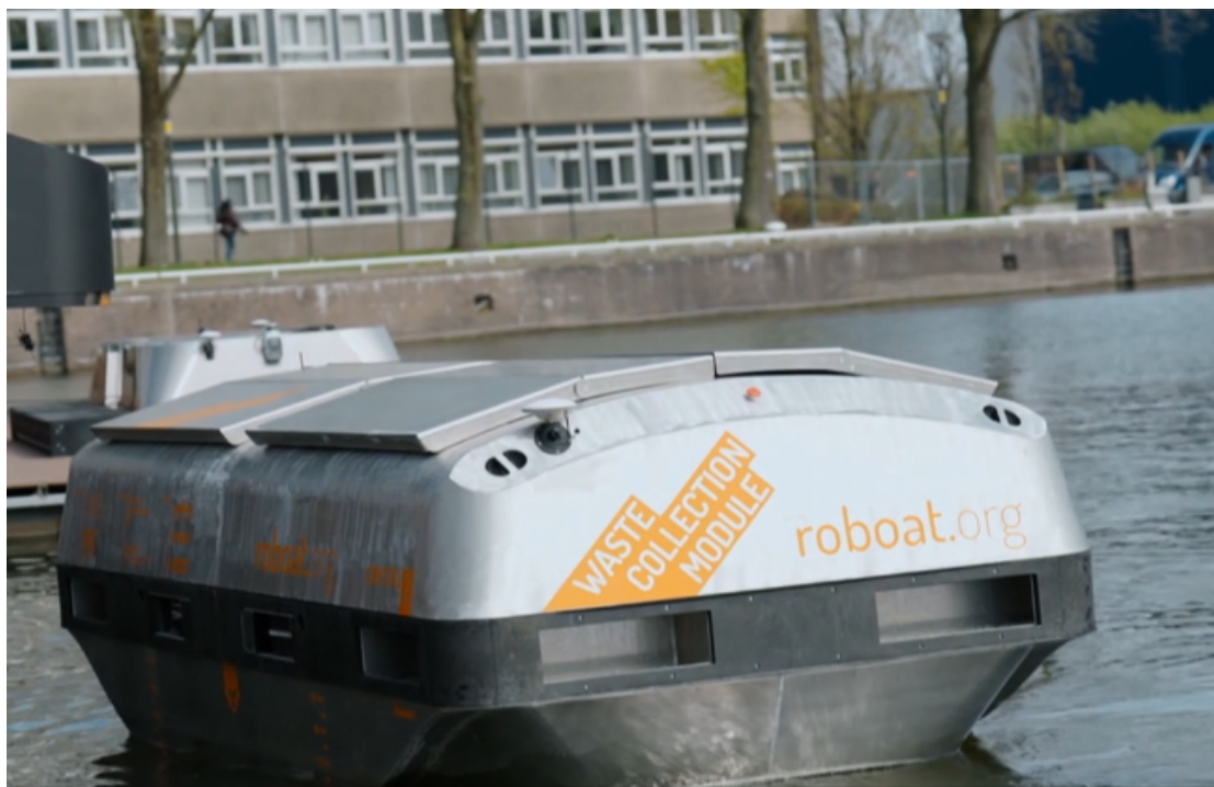
Figura N.º 2 : Módulo autónomo de recolección de residuos del proyecto Roboat, Ámsterdam.
