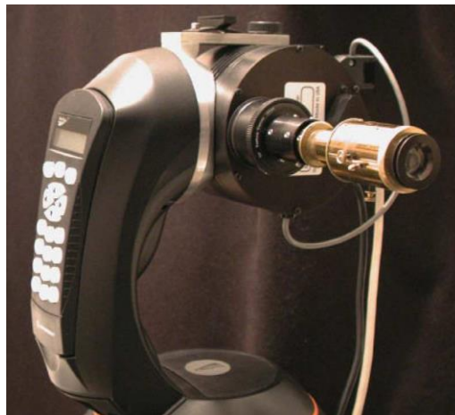
Figura N°9: El espectrofotómetro WASBAM- SSH
