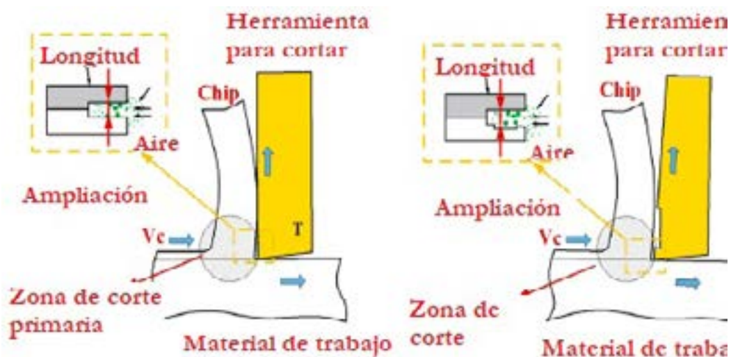
Figura N°14: Mecanismo de herramienta microtexturizada.
