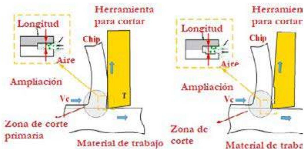
Figura N°14: Mecanismo de herramienta microtexturizada.
