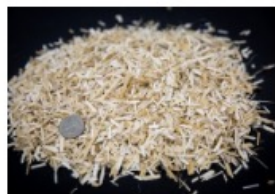
FiberTrack 660 Hurd de tamaño mediano Hurd de FiberTrack 660 dimensionado a un tamaño mediano (longitud de 1/2 pulgada)
