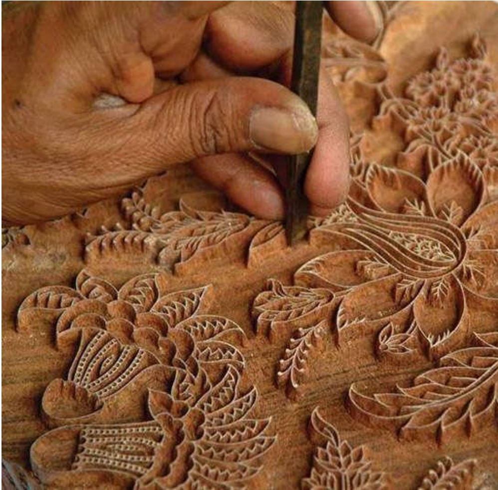
Ilustración 4. Elaboración de un sello de estampación sobre teka, Rajasthan.
