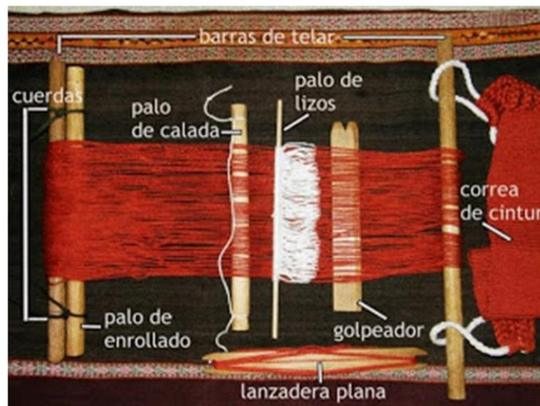
Figura N° 2: Partes del telar cintura.
